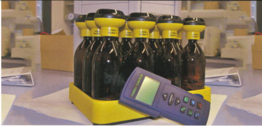
Ampolles amb capçals, safata d'agitació i unitat de control de DBO
